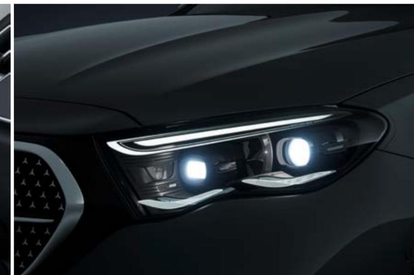
DIGITAL LIGHT (P35) mit Adaptiver Fernlicht-Assistent Plus (628)<sup>1</sup>
