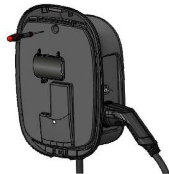
7. Schneiden Sie die Membran der größten Durchführungstülle (12) an: Durch diese Öffnung führen Sie nun die Zuleitung ein.
