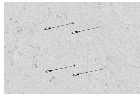
4. Verschrauben Sie mit dem Schraubendreher TX30 zwei der vier mitgelieferten Spanplattenschrauben 6 x 60 mit einem Abstand von 4 mm zur Wand in den beiden oberen Bohrungen.
