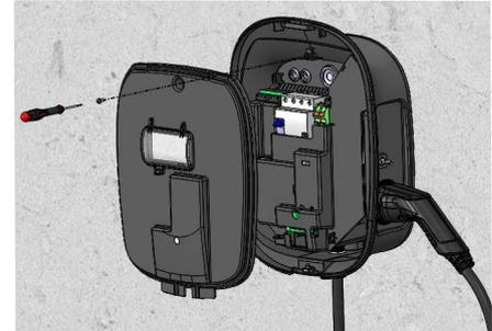
12. Hängen Sie die Gehäuseblende am oberen Rand der Gehäuserückschale ein und verriegeln Sie sie mit dem mitgelieferten Blendenschlüssel.
