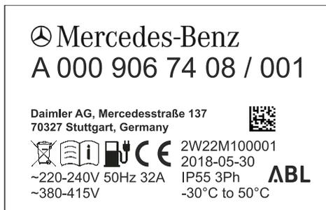
Für die Identifikation sind insbesondere die Modellbezeichnung (A 000 906 XX XX) sowie die darunter angegebenen Werte zum Netzanschluss (Spannung, Netzfrequenz, Stromstärke) relevant.
