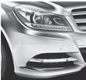
Intelligent Light System mit LED-Tagfahrleuchte
