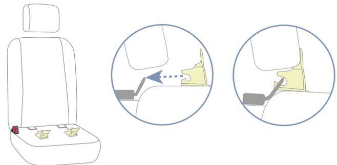
► Klemmen Sie die zwei Einführhilfen 2 mit nach obenweisendem Ausschnitt auf die ISOFIX-Haldebügel 1 des Fahrzeugsitzes.
