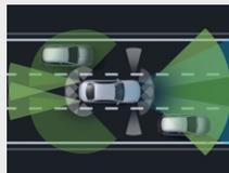
Bitte beachten Sie die folgenden Abhängigkeiten für Bestandteile und Funktionen des Fahrassistenz-Paket Plus: Festplatten-Navigation (365) erforderlich für: Aktiver Stau-Assistent, Streckenbasierte Geschwindigkeits-Anpassung mit Stauendefunktion, Rettungsgassenfunktion des Aktiven Lenk-Assistenten, Aktiver Geschwindigkeitslimit-Assistent und Verkehrszeichen-Assistent.
