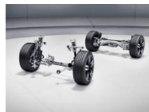
Die AIR BODY CONTROL ermöglicht mit ihrer stufenlosen Dämpfungsregelung an jedem einzelnen Rad ein besonders sanftes Abrollverhalten. Sie fahren so mit überragendem Komfort, schützen Ihren Rücken vor vermeidbaren Belastungen und kommen entspannter an. Außerdem passt sich das Fahrwerk automatisch an verschiedene Beladungszustände an.
