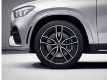
Bitte beachten Sie: Je geringer bei einer bestimmten Radgröße der Querschnitt der Reifen ist, desto schlechter ist der Fahrkomfort auf schlechten Straßen. Abroll- und Dämpfungskomfort nehmen ab und die Gefahr, dass es beim Überfahren von Hindernissen zu Beschädigung von Reifen und Rädern kommt, steigt.
