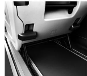
Sitzschienensystem mit Schnellverriegelung zum Ein- und Ausbau der Fondsitze
