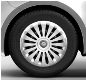
40,6 cm (16") Stahlräder mit Radvollabdeckung, mit 195/65 R 16 auf 6,5 J x 16 ET 52
