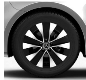
43,2 cm (17") Leichtmetallräder, schwarz, glanzgedreht, mit Bereifung 225/55 R 17 (R1N)
