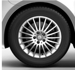
43,2 cm (17") Leichtmetallräder im 20-Speichen-Design, vanadiumsilber lackiert, mit Bereifung 225/55 R 17 auf 7 J x 17 ET 51 (RK8)
