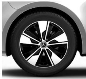
45,7 cm (18") Leichtmetallräder, schwarz, glanzgedreht, mit Bereifung 245/45 R 18 (R1P)
