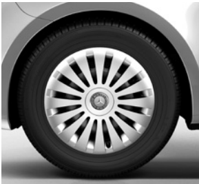
40,6 cm (16") Stahlräder mit Radvollabdeckung, mit 195/65 R 16 auf 6,5 J x 16 ET 52
