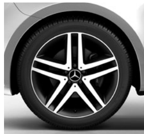
48,3 cm (19") Leichtmetallräder, schwarz lackiert, Front glanzgedreht, mit Bereifung 245/45 R 19 (RL3), nur i. V. m. Line SPORT, siehe ab S. 28
