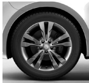
45,7 cm (18") Leichtmetallräder, tremolitgrau, mit Bereifung 245/45 R 18 (RL9)
