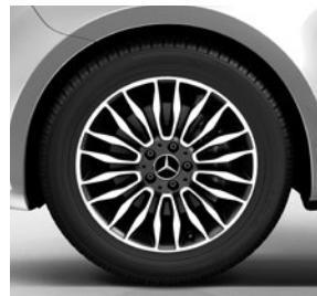
45,7 cm (18") Leichtmetallräder, schwarz lackiert, Front glanzgedreht, mit Bereifung 245/45 R 18 (RK2)
