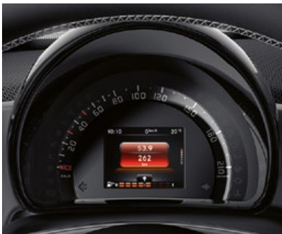
BRABUS Kombiinstrument mit farbigem 8,9 cm (3,5") Display in TFT-Technologie und Bordcomputer
