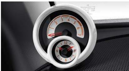
Zusatzinstrument mit Cockpituhr und Drehzahlmesser [V31]
